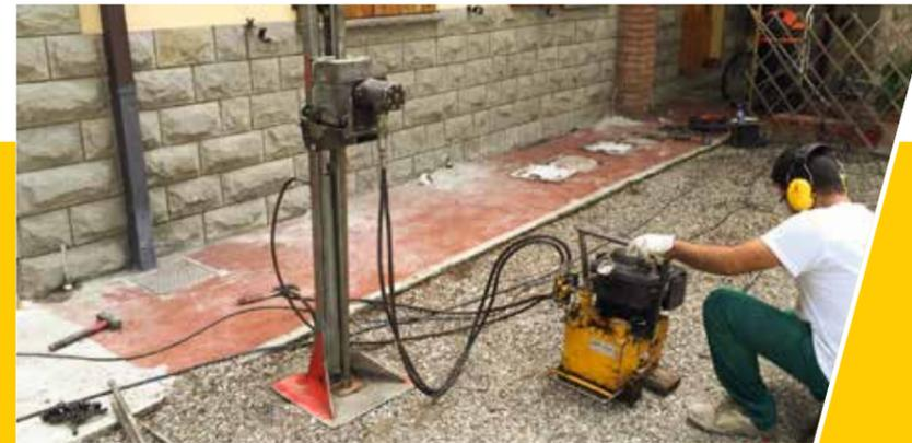
Le prove geologiche pre e post iniezione sono essenziali per verificare di aver ottenuto nel terreno i miglioramenti geotecnici di progetto.
