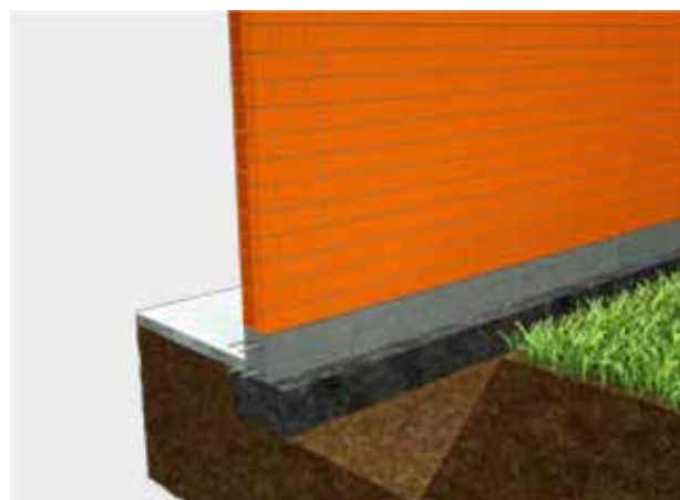
1 Cordolo/trave in e.a. con basamento non armato
