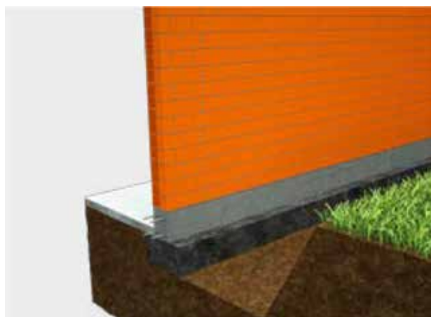
1 Cordolo/trave in e.a. con basamento non armato
