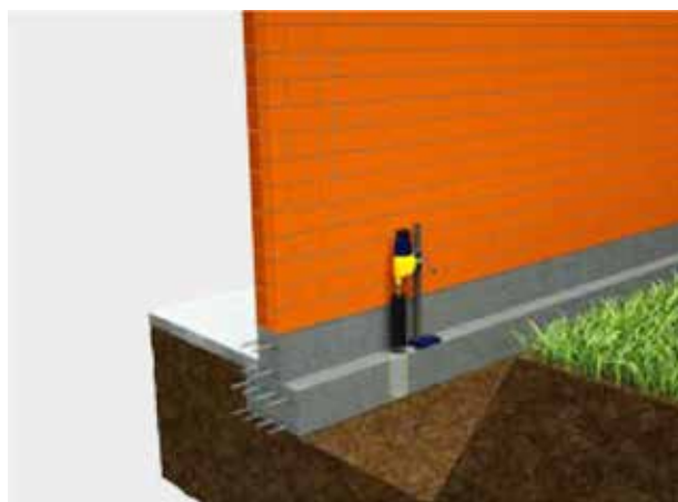
2 Carotaggio dell'ala di fondazione
