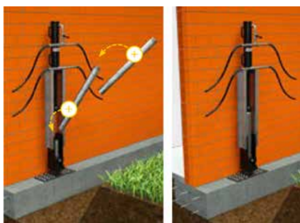
4 Pressoinfissione dei pali modulari
