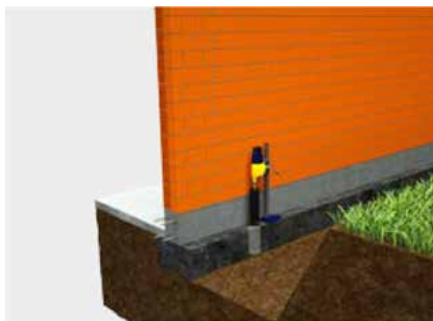
2 Carotaggio del basamento
