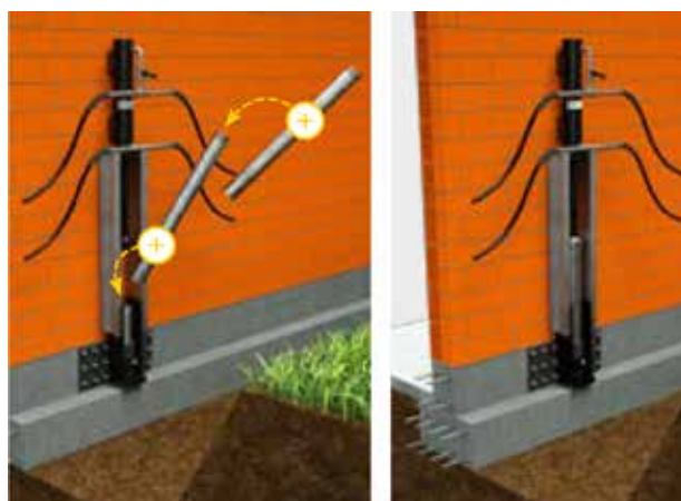
4 Pressoinfissione dei pali modulari
