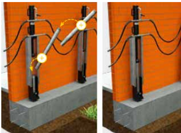
4 Pressoinfissione dei pali modulari
