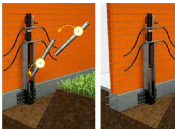
4 Pressoinfissione dei pali modulari
