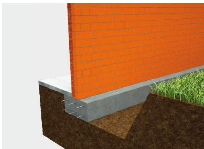
① Fondazione in c.a. di sezione di larghezza ben superiore alla muratura.
