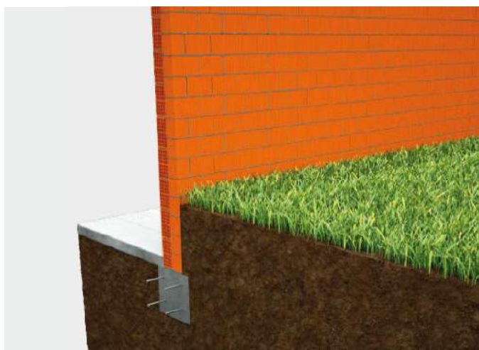
① Scavo a scoprire il bordo della fondazione
