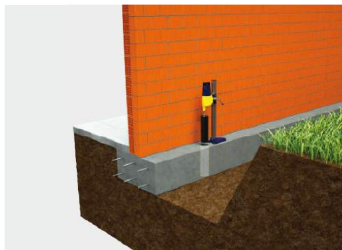
② Carotaggio della fondazione.
