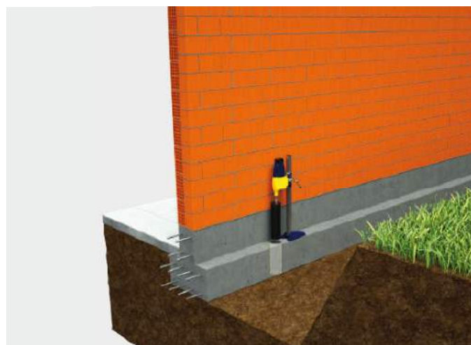
② Carotaggio dell'ala di fondazione.
