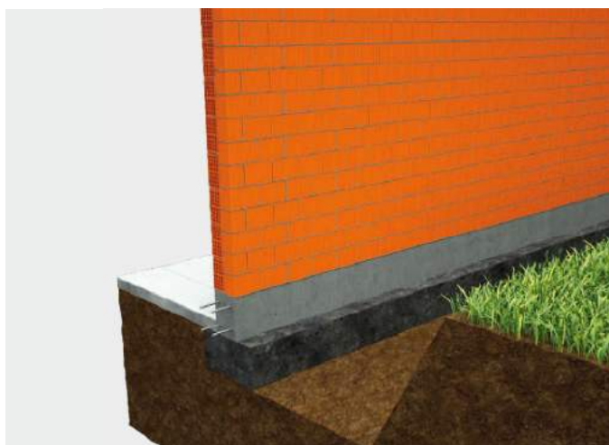
① Cordolo/trave in c.a. con basamento non armato
