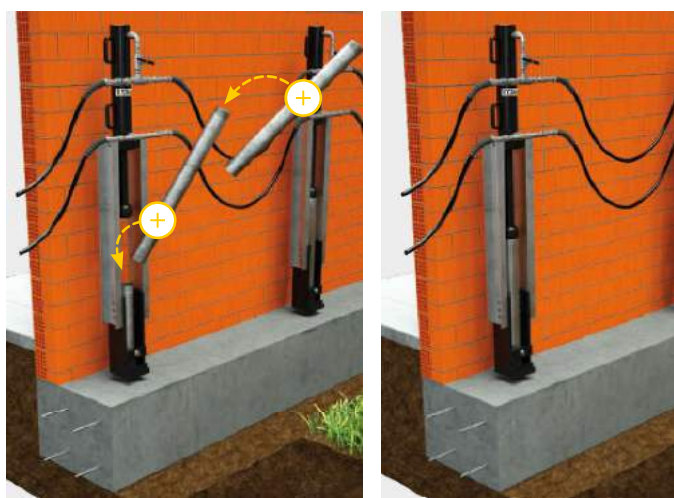
⑤ Pressoinfissione dei pali modulari.
