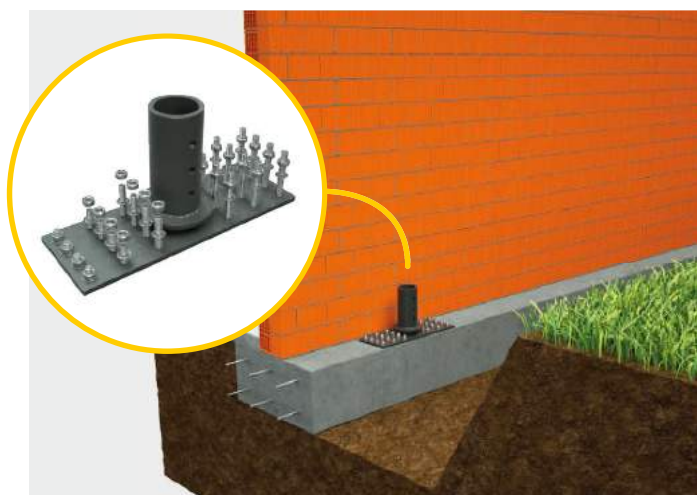
③ Tassellatura della piastra all'estradosso della fondazione.
